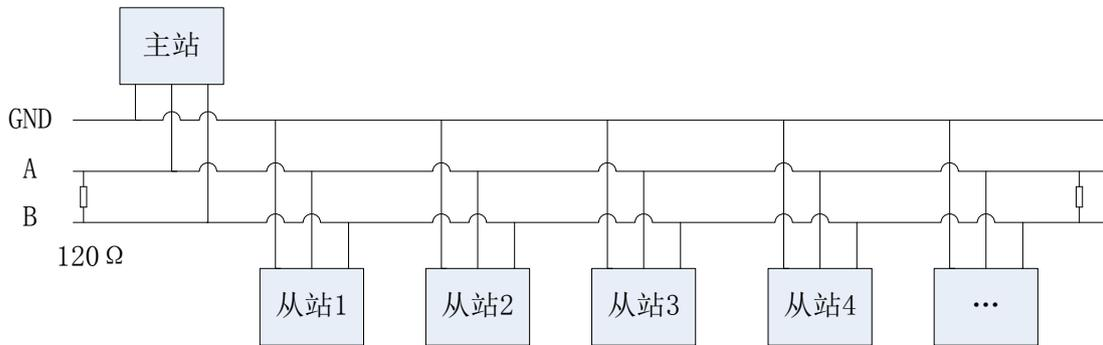
图 4 RS485 通讯接线示意图
