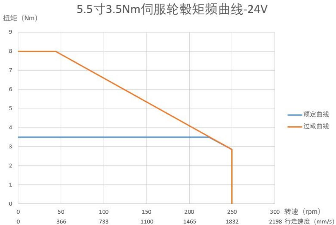
图 2.1.4 5.5 寸 3.5Nm 轮毂电机特性曲线
