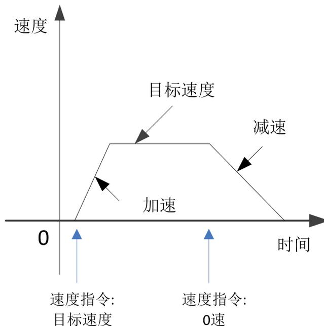
图 6.2-1 带加减速的速度模式
