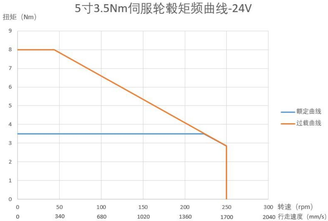
图 2.1.4 5 寸 3.5Nm 轮毂电机特性曲线
